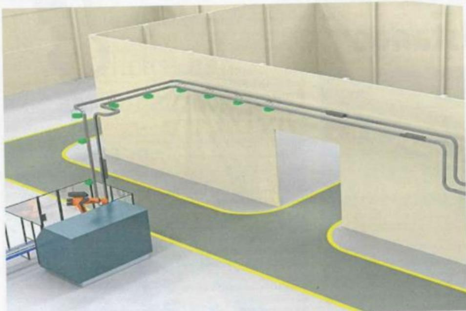
In der Führungsbahn fahren Züge oder Wagen, an die beliebig gestaltete Transporteinheiten – etwa als Werkstückträger – montiert werden können.
