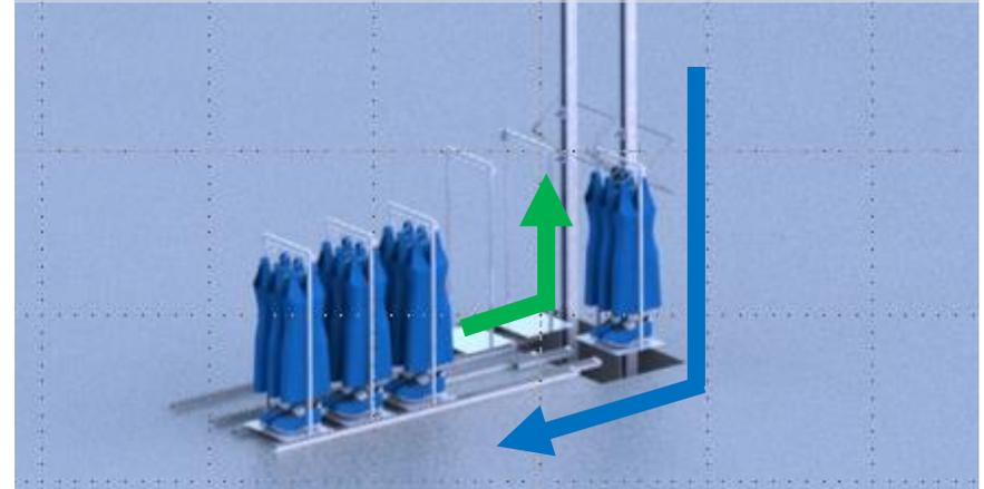
Auf gleiche Weise wird Ware **abtransportiert** – einfach auf der Rollenbahn absetzen, Quick MOVE übernimmt wenig später.
